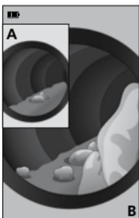
4. A kiválasztott (A) referenciaikép megjelenik a kijelzőn, a háttérben összehasonlításként fut a (B) előkép. Az (A) referenciaikép eltüntetéséhez nyomja meg a Galéria gombot.
