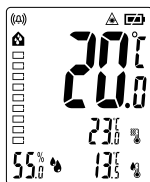
Разлика околна температура/повърхностна температура: <math>< 3,5^{\circ}\text{C}</math> без топлинен мост
