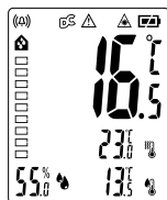
Разлика околна температура/повърхностна температура: \geq 6,5^{\circ}\text{C} топлинен мост, дисплеят свети синьо и символът „ \Delta ” мига
