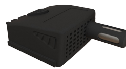
Modul klimatických podmienok (MCC) Meracie rozsahy 0 až +50°C, 800 až 1100 hPa a 5 až 95%RH
