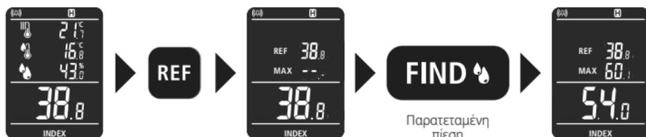
Με τη λειτουργία αναφοράς μπορείτε να έχετε μια επισκόπηση της κατανομής υγρασίας στον τοίχο. Αναζητήστε ένα στεγνό σημείο στο υλικό μέτρησης και βρείτε την περιεκτικότητα υγρασίας όπως περιγράφεται στο κεφάλαιο 6 «Διαδικασία μέτρησης». Συγκρατήστε την τιμή μέτρησης ως τιμή αναφοράς πιέζοντας το πλήκτρο «REF». Εκτελέστε μια μέτρηση υγρασίας σε ένα άλλο σημείο. Θα βρείτε μια επισκόπηση της τιμής αναφοράς, της μέγιστης τιμής μέτρησης και της τρέχουσας τιμής μέτρησης.
