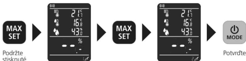
Existují 3 skupiny materiálů: cementový potěr, anhydritový potěr a beton v hmotnostních procentech a procentech CM. Po restartu zůstává zachován poslední použitý materiál.
