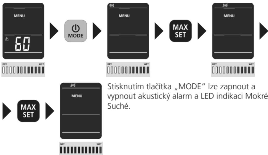
Stisknutím tlačítka „MODE“ lze zapnout a vypnout akustický alarm a LED indikaci Mokrá/ Suché.
