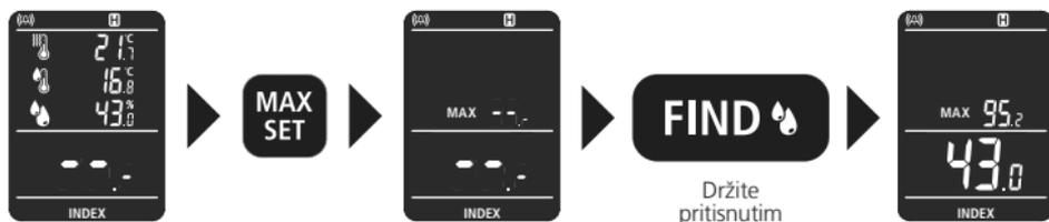
Uređaj može držati MAKS. vrijednost samo unutar postupka mjerenja. MAKS. vrijednost prikazuje se nakon postupka mjerenja. Pritiskom na tipku „FIND” prilikom ponovnog mjerenja prikazuju se MAKS. vrijednost i aktualna vrijednost.
