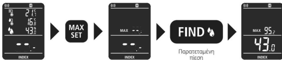
Η συσκευή μπορεί να διατηρεί τη MAX τιμή μόνο εντός μιας διαδικασίας μέτρησης. Μετά από τη διαδικασία μέτρησης εμφανίζεται η MAX τιμή. Σε νέα μέτρηση με παρατεταμένη πίεση του πλήκτρου «FIND» εμφανίζεται η τιμή MAX και η τρέχουσα τιμή.
