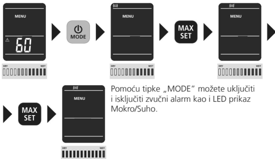
Pomoću tipke „MODE” možete uključiti i isključiti zvučni alarm kao i LED prikaz Mokro/Suho.
