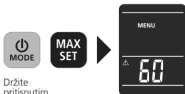
U izbornik se dopijeva istovremenim pritiskanjem tipki ON/OFF i MAX. Ovdje je moguće namjestiti vrijednost praga za suho, alarm i automatsko isključivanje.
