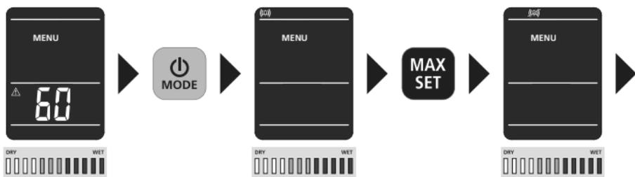
Натисканням кнопки «MODE» ви можете налаштувати попереджувальний сигнал, а також вмикати та вимикати світлодіод індикації вологості/сухості.
