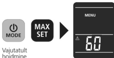
ON/OFF- ja MAX-klahvi samaaegsel vajutatult hoidmisel liigutakse menüüsse. Siin saab seadistada kuiva-piirväärtuse, häire ja automaatse väljalülitumise.
