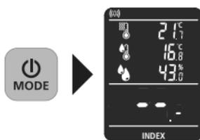
**Indexový režim** slouží pro rychlé vyhledání vlhkosti pomocí srovnávacích měření, **bez** přímého udání vlhkosti materiálu v %. Uvedená hodnota (0 až 199,9) je indikovaná hodnota, která stoupá se vzrůstající vlhkostí materiálu. Měření prováděná v indexovém režimu, jsou nezávislá na materiálech, resp.
