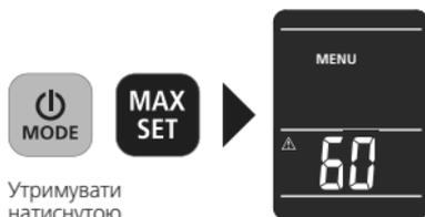
Щоб увійти в меню, натисніть та утримуйте кнопки ON/OFF та MAX одночасно. Тут ви можете налаштувати граничне значення сухості, функцію попереджувального сигналу та автоматичного відключення.
