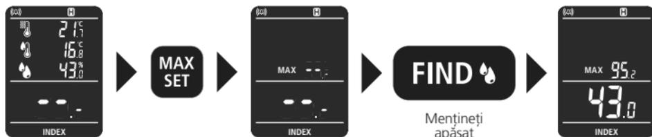
Unitatea poate menține doar valoarea MAX în cadrul unui proces de măsurare. După procesul de măsurare, se afișează valoarea MAX. Când măsurați din nou apăsând și menținând apăsată tasta "FIND", se afișează valoarea MAX și valoarea curentă.
