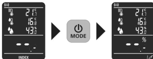
Uređaj ima 2 načina mjerenja vlage, ovisno o materijalu. Pritiskom na tipku „MODUS” vrši se prebacivanje između centralnog, indeksnog modusa koji ne ovisi o materijalima, i dodatnog modusa za građevinske materijale.
