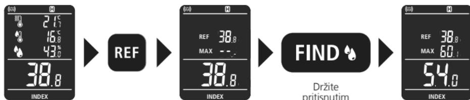
Pomoću funkcije reference možete dobiti uvid u raspodjelu vlage u zidu. Pronađite suho mjesto na materijalu koji se mjeri i utvrdite udio vlage na način opisan u poglavlju 6 „Postupak mjerenja”. Pritiskom na tipku „REF” zadržite mjernu vrijednost kao referentnu vrijednost. Mjerenje vlage izvršite na nekom drugom mjestu. Dobivate pregled referentne vrijednosti, maksimalne mjerne vrijednosti i aktualne mjerne vrijednosti.
