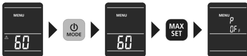
Seade on varustatud automaatse väljalülitusega. See võib toimuda 3 minuti või 60 minuti möödumisel. Seadme hügromeetrina kasutamisel ruumikliima jälgimiseks on mõttekas automaatse väljalülituse seadistus 60 minuti möödumisel.
