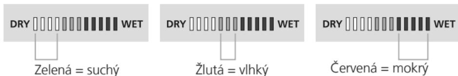
**!** Klasifikace „sucho“ znamená, že materiály dosáhly ve vyhřívaném prostoru ustálené vlhkosti a tím jsou zpravidla vhodné pro další zpracování.
