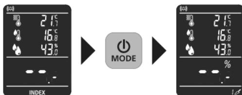
Aparatul dispune de 2 moduri pentru măsurarea umidității în funcție de material. Prin apăsarea butonului "MODE" se comută între modul INDEX central, independent de material, și modul suplimentar pentru materiale de construcție.
