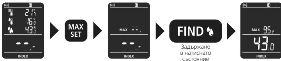
Уредът може да запазва максималната стойност само в рамките на измерването. Максималната стойност се показва след завършването на измерването. При следващо измерване чрез задържане в натиснато състояние на бутона „FIND“ се показват максималната стойност и текущата стойност.
