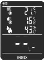
Indeksni način se koristi za brzo otkrivanje vlage putem usporednih mjerenja, bez izravnog izlaza sadržaja vlage materijala u %. Vraćena vrijednost (0 do 199,9) je indeksirana vrijednost koja raste s povećanjem vlažnosti materijala. Mjerenja napravljena u indeksnom načinu rada neovisna su o materijalu ili za materijale za koje nisu pohranjene karakteristične krivulje. Ako vrijednosti unutar usporednih mjerenja značajno odstupaju, profil vlage u materijalu može se brzo lokalizirati.
