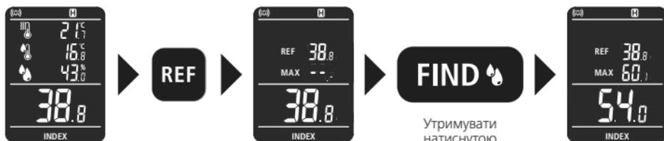
Ви можете використовувати функцію контрольного значення для отримання уявлення про розподіл вологи в стіні. Знайдіть сухе місце на вимірюваному матеріалі та визначте вміст вологи, як описано в розділі 6 «Процес вимірювання». Натисканням кнопки «REF» збережіть виміряне значення як контрольне значення. Виміряйте вологість в іншому місці. Ви зможете порівняти контрольне, максимальне та поточне виміряне значення.
