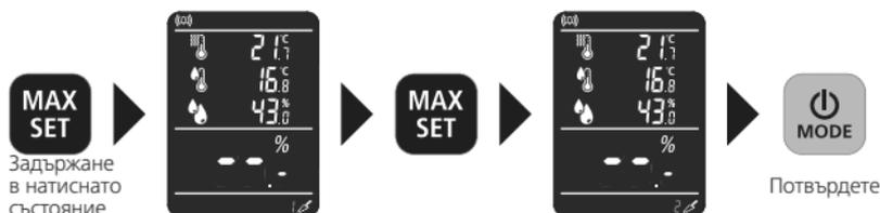
Има 3 групи материали: циментова замазка, анхидритна замазка и бетон, като % маса и % CM. След рестартиране се запазва последният използван материал.
