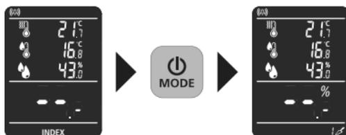
Režim má 2 režimy pro měření vlhkosti, v závislosti na materiálu. Stisknutím tlačítka „MODE“ se přepíná mezi centrálním, materiálově nezávislým režimem INDEX a dodatečným režimem Stavební materiál.
