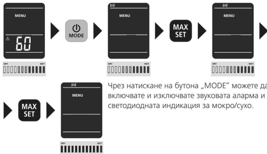
Чрез натискане на бутона „MODE“ можете да включвате и изключвате звуковата аларма и светодиодната индикация за мокро/сухо.
