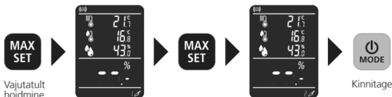
On 3 materjaligrupi: Tsementpõrand, anhüdriidpõrand ja betoon igaüks massi-% ja CM-% kujul. Pärast uuesti käivitamist säilitatakse viimati kasutatud materjal.
