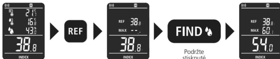
Pomocí referenční funkce lze získat přehled o rozložení vlhkosti ve stěně. Najděte suché místo na měřeném materiálu a zjistěte obsah vlhkosti podle popisu v kapitole 6 „Proces měření“. Stisknutím tlačítka „REF“ stanovte naměřenou hodnotu jako referenční hodnotu. Proveďte měření vlhkosti na jiném místě. Tak získáte přehled o referenční hodnotě, maximální naměřené hodnotě a aktuální naměřené hodnotě.
