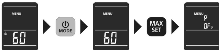
Přístroj má funkci automatického vypnutí. Může se provést po 3 nebo 60 minutách. Používá-li se přístroj jako vlhkoměr k monitorování klimatu v místnosti, je užitečné nastavit automatické vypnutí po 60 minutách.
