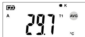
**A** Stisknutím tlačítka A se zobrazí hodnoty MAX, MIN, AVG čidla T1 a diferenciální hodnota T2-T1.
