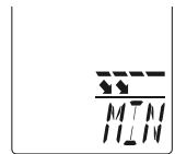
6. Temperatură infraroșu minimă
