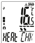
Okolní teplota: 20°C Případný tepelný most, oblast dále zkoušet
